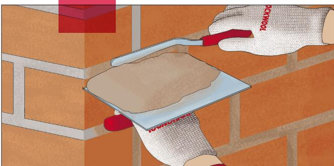
7. Заделка швов может проводиться не ранее чем через 14 дней после приклеивания плитки. Приготовленный состав для затирки швов выкладывают на терку и заделывают вертикальные и горизонтальные швы соответствующей по ширине кельмой.
