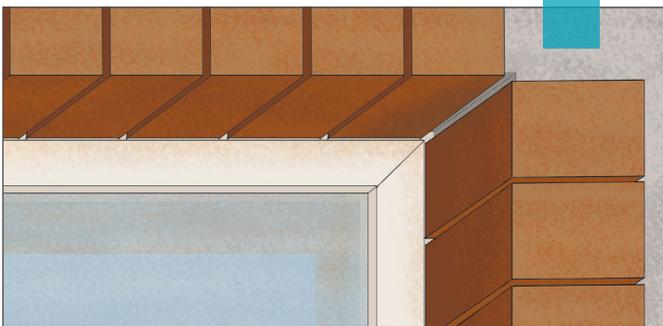
5. Монтаж необходимо начинать с укладки угловых облицовочных плиток. Далее укладываются плоские облицовочные плитки.
