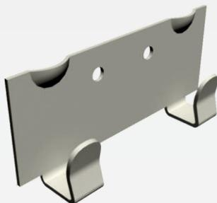
Для крепления облицовочной плитки керамогранита используются пружинные кляммеры. Стартовый кляммер необходим для установки первого ряда плит, а так же плит над проемами и выступами. Существуют модификации кляммера под разную толщину керамогранита – 8 мм и 10 мм.
