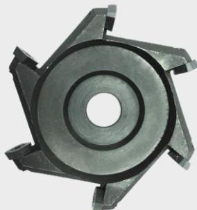
Фрезы с твердосплавными сменными пластинами и углом 90° предназначены для формирования паза в листовом композитном материале для дальнейшей сборки облицовочной кассеты. Сменные поворотные пластины увеличивают срок службы фрезы в 4 раза.
