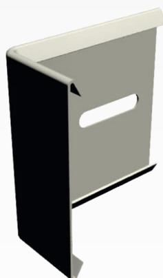
Удлинитель кронштейна позволяет компенсировать неровности стены. К несущему кронштейну может крепиться как при помощи вытяжной заклепки и болтового соединения, так и при помощи двух вытяжных заклепок.
